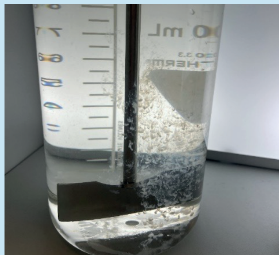
Figura 2: Pérdida de efectividad del polisulfato en ausencia de agitación
