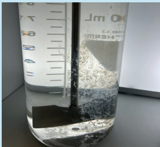
Figura 2: Perda de eficácia do polissulfato na ausência de agitação
